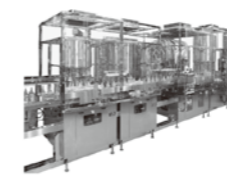
〈写真〉液体充填ライン 〈製品例〉ケチャップ、醤油などの充填、キャッピング
